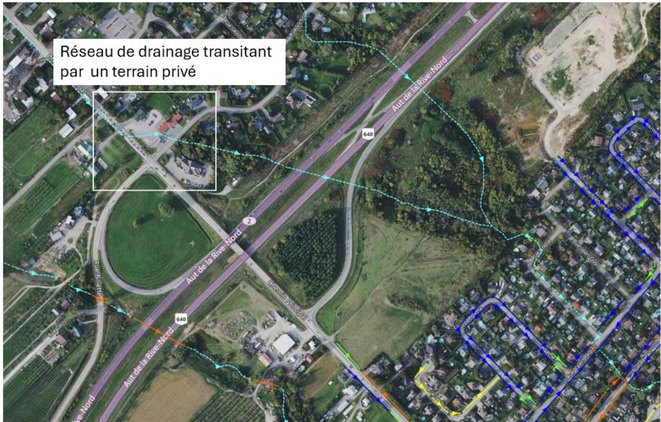
Figure 5-9: Réseau de drainage transitant par un terrain privé - Secteur de la rue Valéri-Paquin
