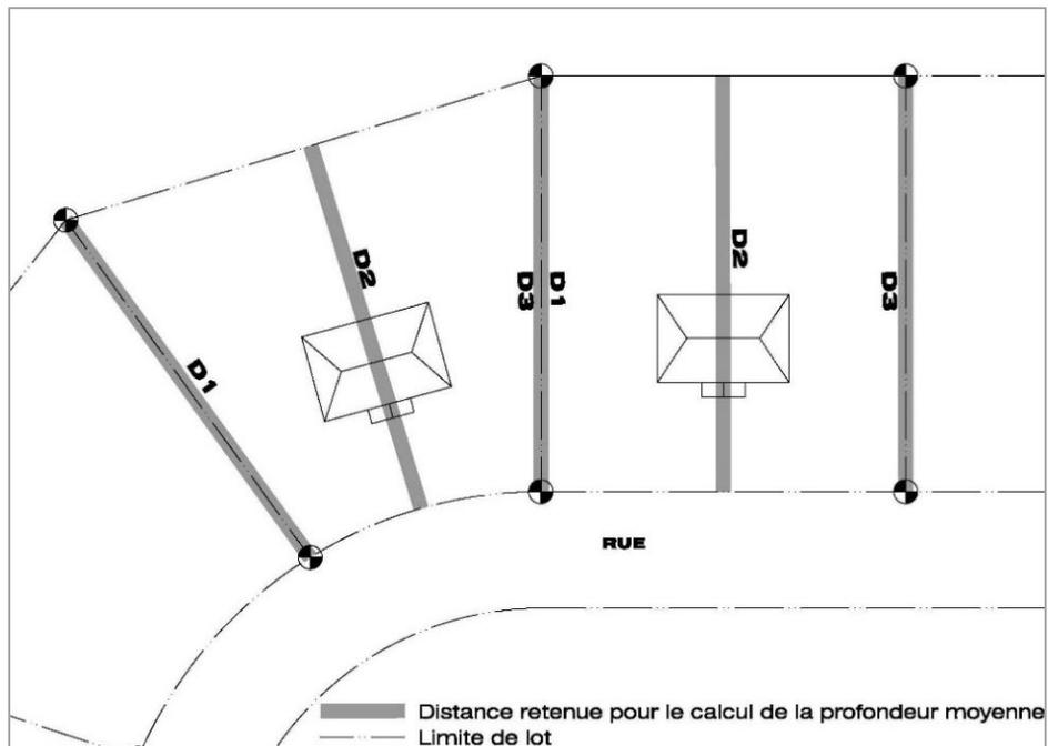
Dans le cas d'un terrain d'angle, la ligne avant de lot faisant face à la façade secondaire du bâtiment doit être considérée dans le calcul de la profondeur d'un lot.
