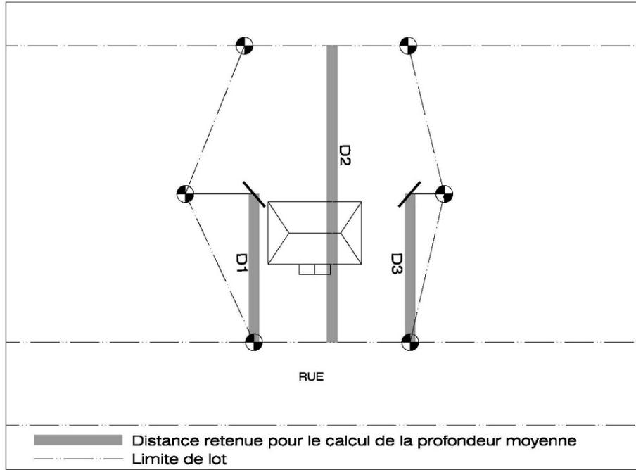
Figure 3 : Calcul de la profondeur moyenne d'un lot irrégulier (exemple 3)
