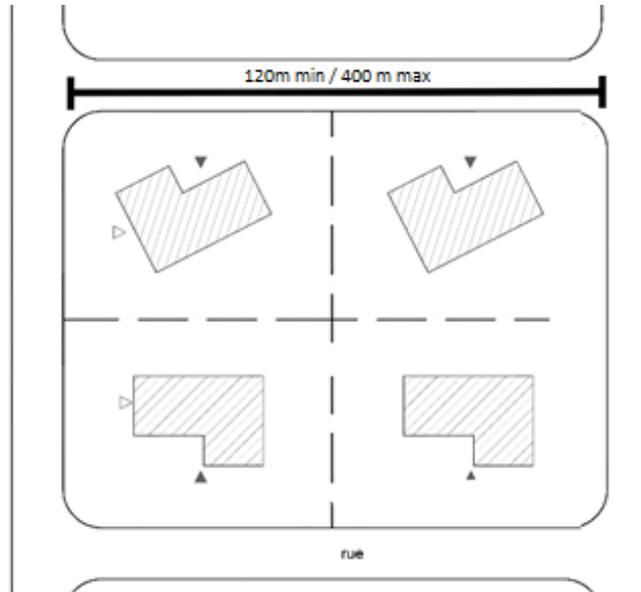
Figure 7 : Longueur maximale d'un îlot en présence d'un sentier piéton central de 5 m de largeur
