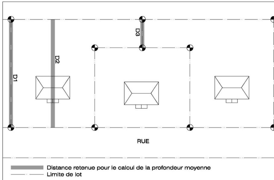
Figure 2 : Calcul de la profondeur moyenne d'un lot irrégulier (exemple 2)
